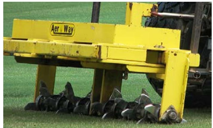
*Los aireadores de corte de trabajo pesado son ideales para ayudar a reducir los problemas de compactación del suelo para un programa de conservación de agua exitoso. Las púas agrietan y rompen los suelos compactados a una profundidad de seis pulgadas o más para abrir nuevos canales para el aire, el agua y el enraizamiento.*
