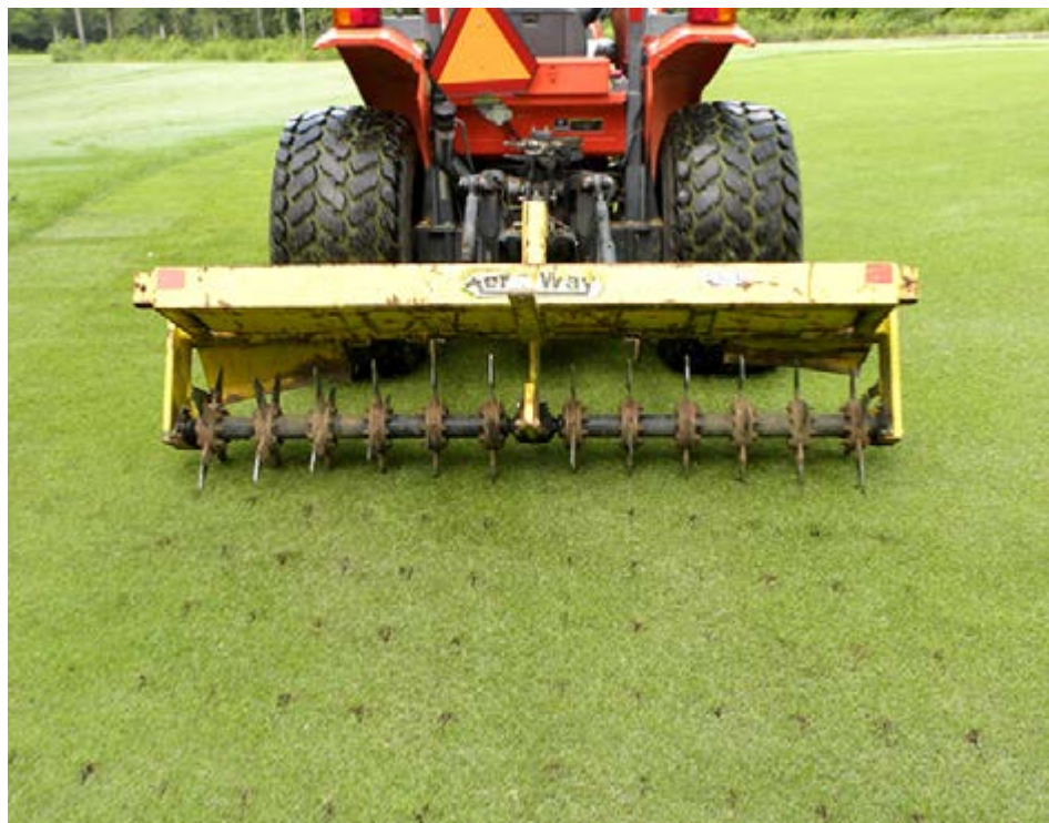
La aireación es una técnica de conservación de agua importante, ya que ayuda a prevenir la pérdida del agua superficial por escurrimiento.
