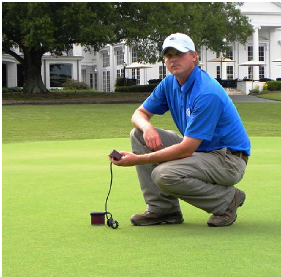
Sensores de humedad del suelo proporcionan a los superintendentes de los campos de golf el estado de humedad del suelo en tiempo real y son una herramienta asequible de conservación de recursos.
