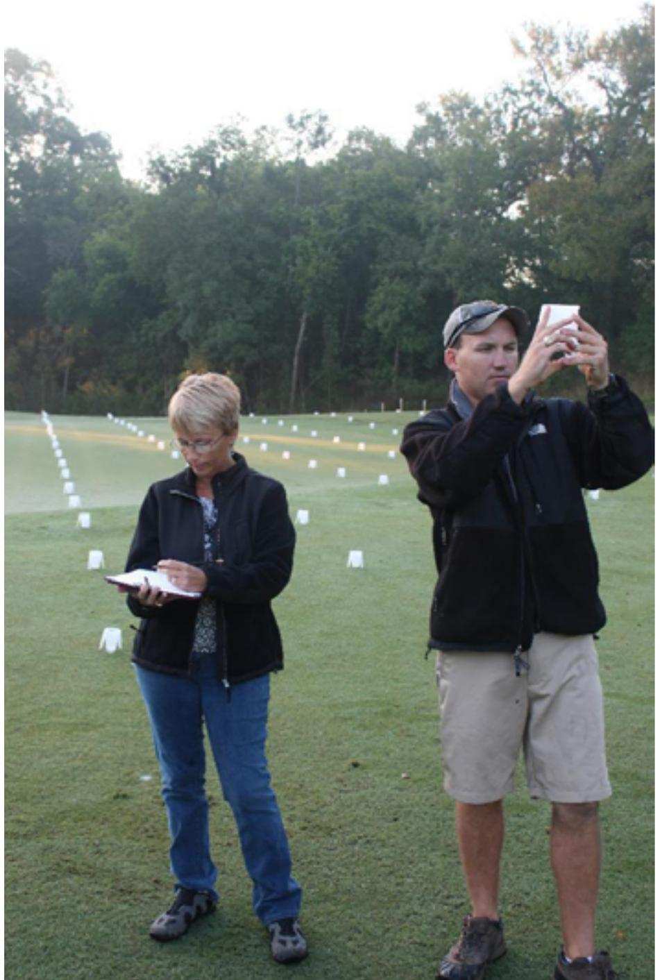
*Realizar un análisis del sistema de riego (catch can test) en varias secciones del campo de golf es una parte de un análisis del sistema de riego. Una vez completado, el análisis proporciona información objetiva sobre el estado del sistema por lo que se pueden planear mejoras o sustituciones futuras. (foto cortesía de Jim Moore.)*
