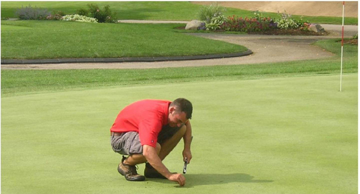
湿度计不能代替草坪表面枯萎病的观察和土壤水分的实质检查。这些传统技术具有主观性，使用湿度计可以最大程度地避免这种固有的缺陷。
