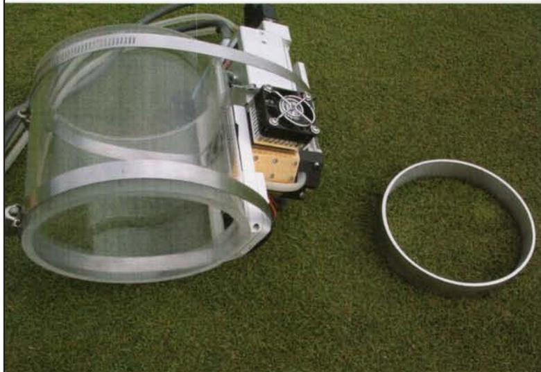
Para determinar la fotosíntesis y la respiración de toda la planta, se cubrió el césped con una cámara de plexiglás transparente conectada a un analizador de dióxido de carbono.
