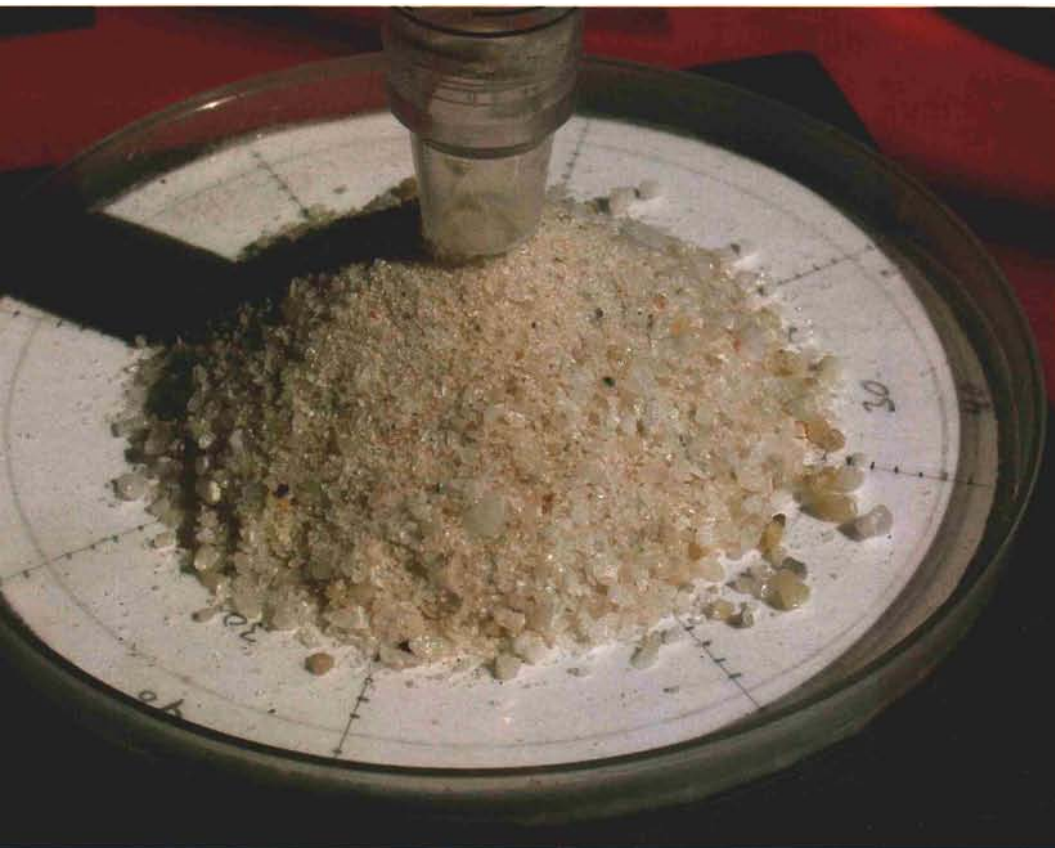
Una medición adicional que puede ayudar a los laboratorios a predecir la firmeza de la arena es el ángulo de reposo. Esta medición es un cálculo expresado en grados, derivado de la medición del diámetro medio de la base y la altura del ápice de un cono de arena seca. Las arenas más angulares y de textura más gruesa con una distribución del tamaño de partículas más amplia son más propensas a acumularse en un nivel superior, lo cual deriva en una base más estrecha y un ápice de cono más alto, finalmente, en un ángulo de reposo mayor.
