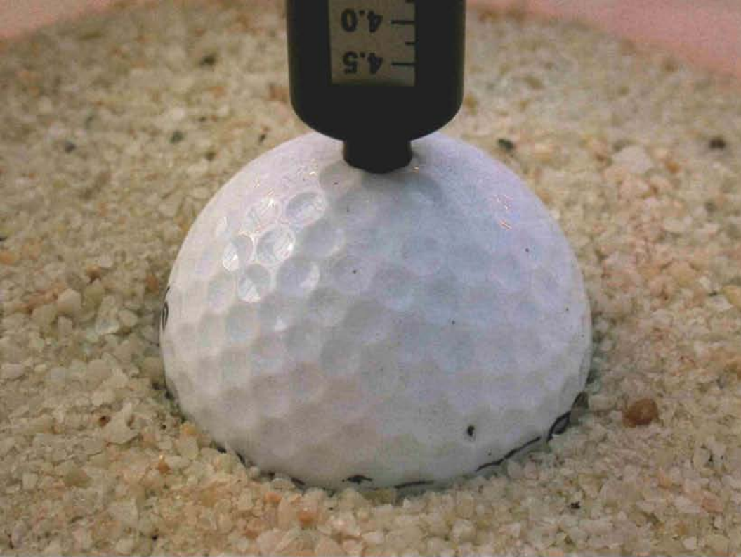
Actualmente, el penetrómetro (el dispositivo que se muestra más arriba) es el mejor medio para cuantificar en el laboratorio la firmeza de la arena de los bunkers. Es posible que el penetrómetro y la prueba de laboratorio pronto sean reemplazados por un nuevo procedimiento que reducirá la variabilidad de la medición actual.
