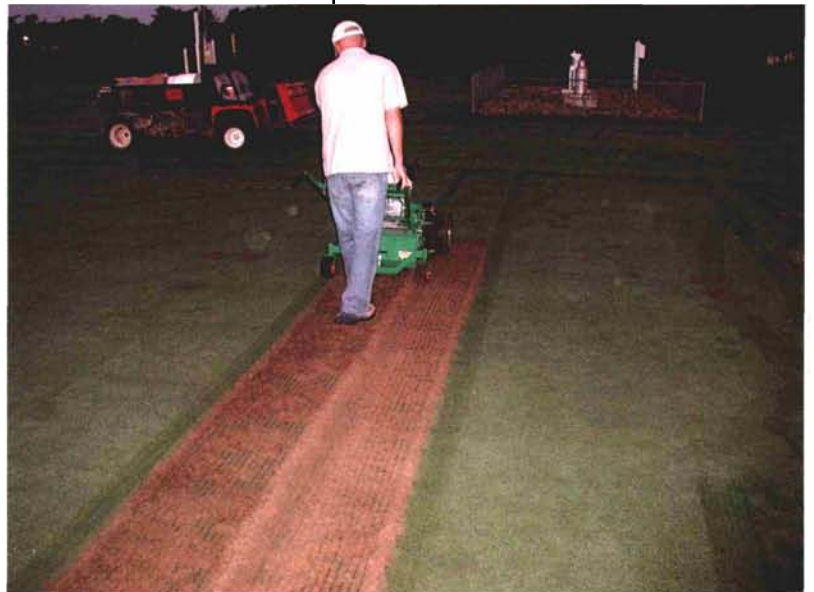
Graden GS04 垂直切割机可以刺穿果岭根系层土壤的有机质层，形成通道。
