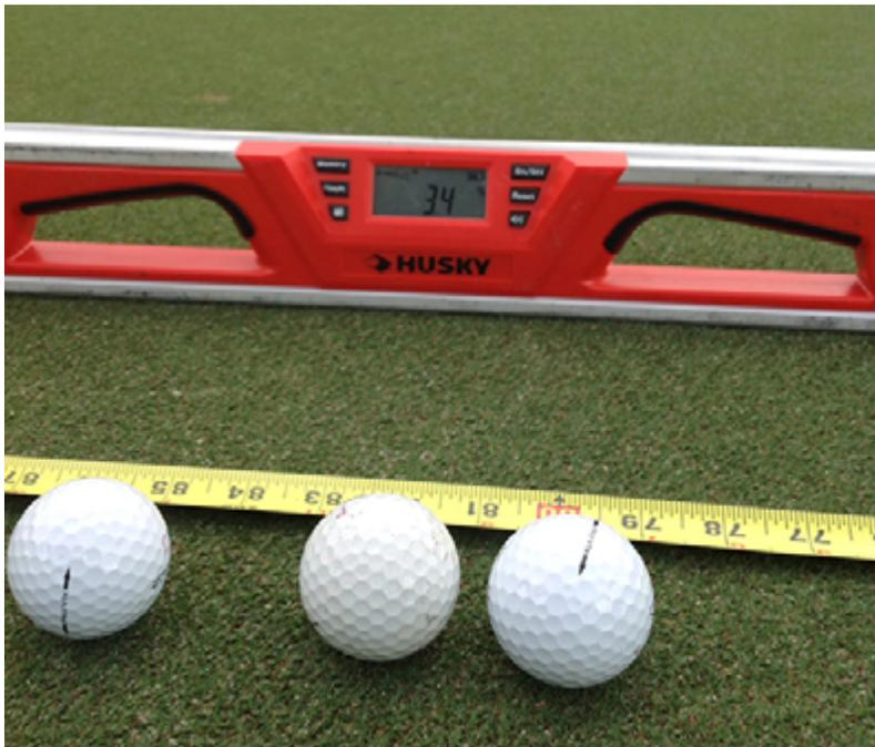
数字水平仪为球洞周边区域的坡度提供了精确的测量。
