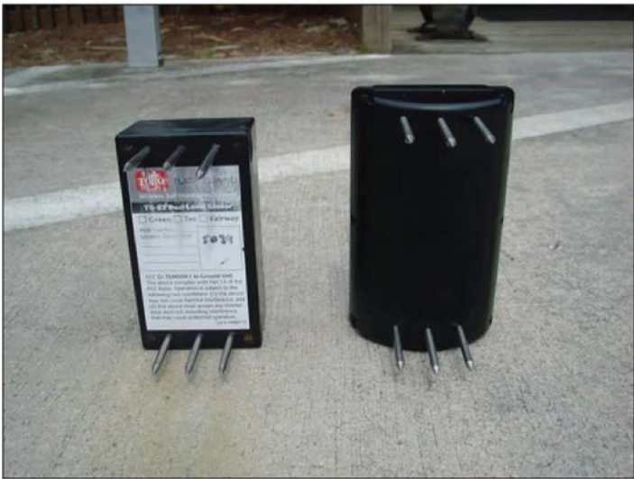
图 4 固定式湿度计能够协助我们执行适当的灌溉应用。
