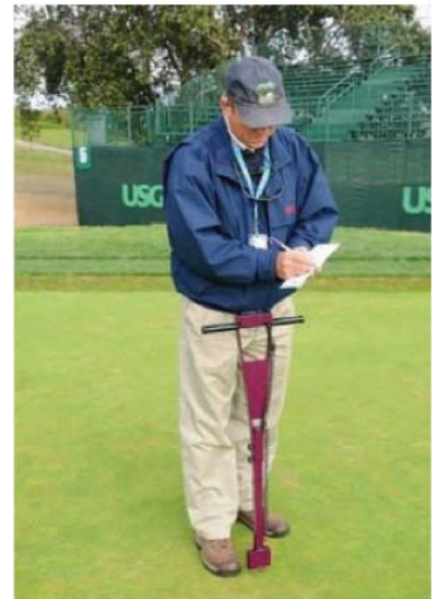
图 5 利用土壤湿度和盐分传感技术在用于整个球场时有节约大量用水的潜力。
