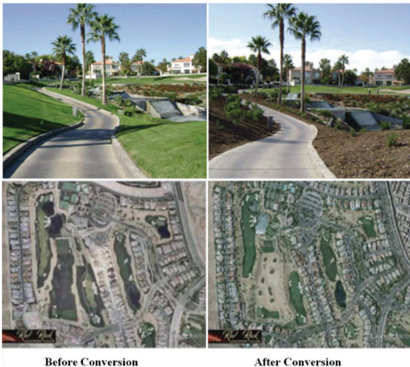
图 5 作为示范的高尔夫球场，把界外区域、房屋周边区域以及练习场的草坪移除。通过由草坪景观到沙漠型景观的转化，我们实现了每平方英尺 34 加仑的节约用水。
