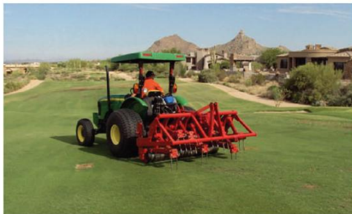
图 3 利用土壤改良方法如深齿曝气，可以减少地表径流并改善土壤水分渗入。
