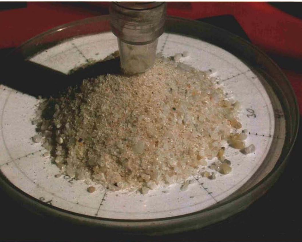
另一种可能有助于实验室预测沙子紧实度的度量指标是安息角。这是一种是以度数表示的度量指标，源自对干沙堆基底和顶部高度平均直径的测量。质地更粗糙、棱角更多、颗粒尺寸分布更广的沙粒更有可能达到更高的堆叠高度，从而带来更窄的基底和更高的锥顶，最终产生更大的安息角。
