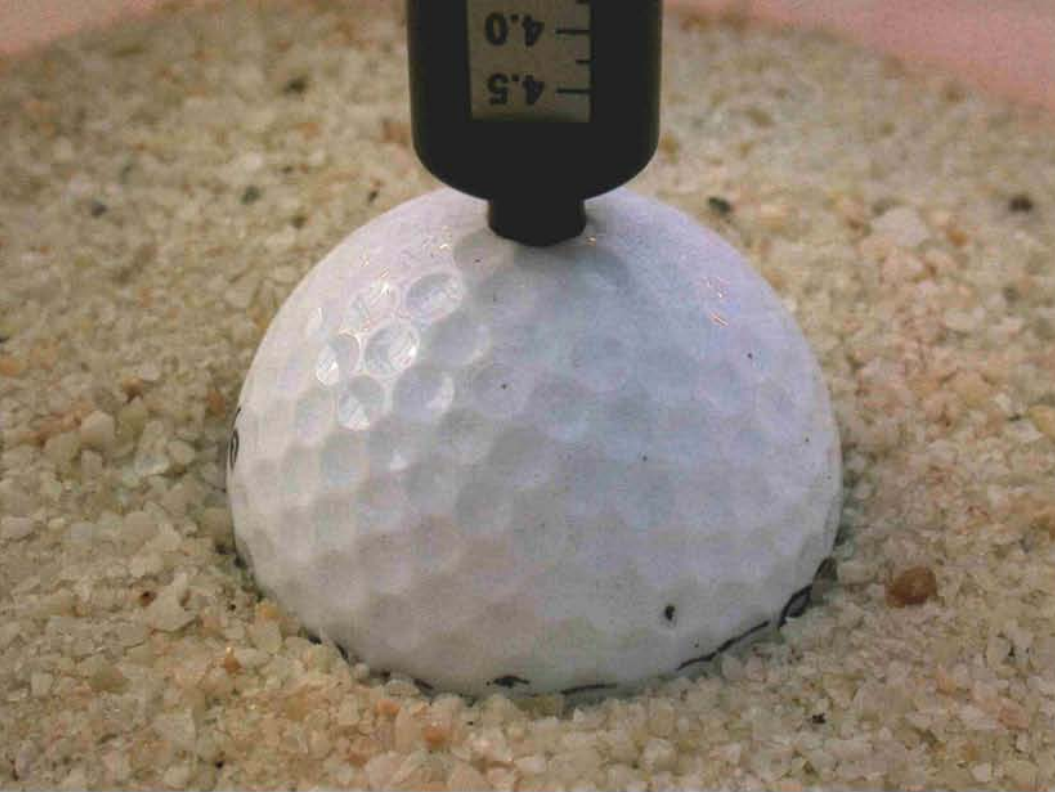
上图所示的贯入仪装置目前是在实验室量化沙坑沙紧实度的最佳方式。不久后，该贯入仪和实验室测试将可能被一项能减少当前测量变量的新流程所取代。
